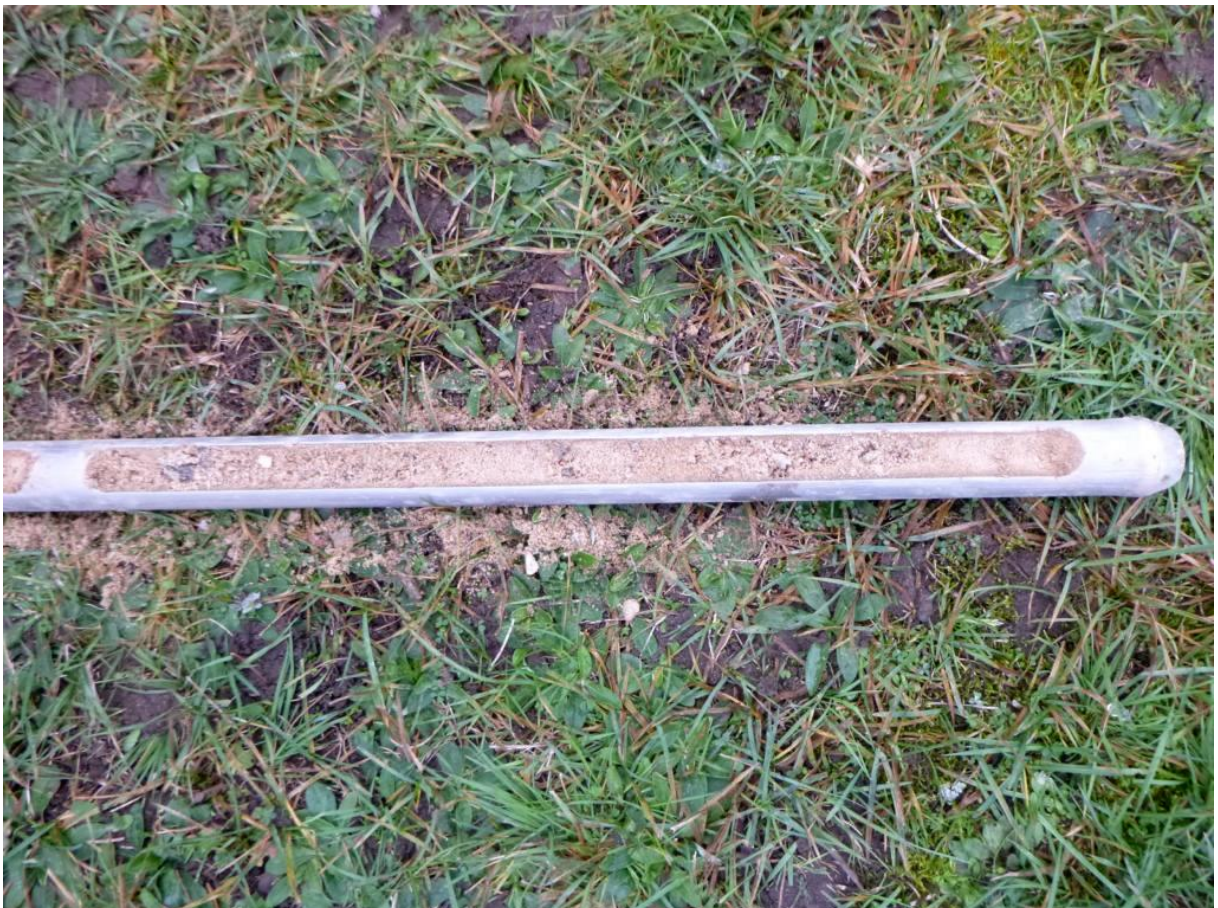
Bild 6: SW-Ecke, Feinsand, feinkiesig, tieferer Bereich bei 4,5-5,0 m.
